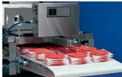
GEA Paper Interleaver para apilar productos intercalados automáticamente en una variedad de arreglos
